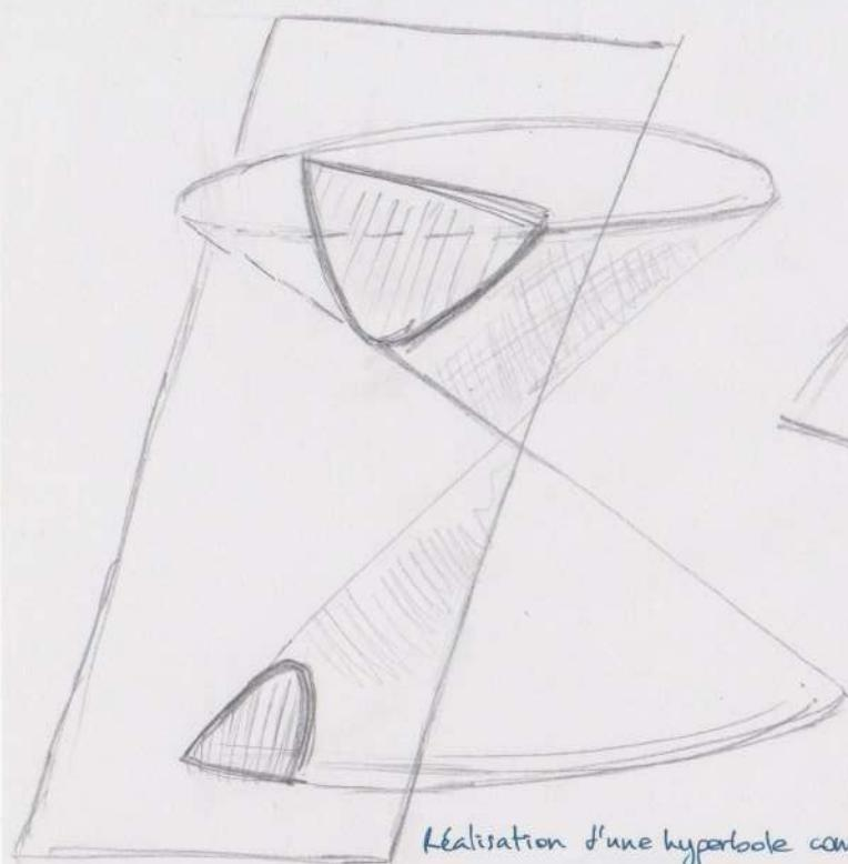
Réalisation d'une hyperbole comme section d'un cône de révolution par un plan.
